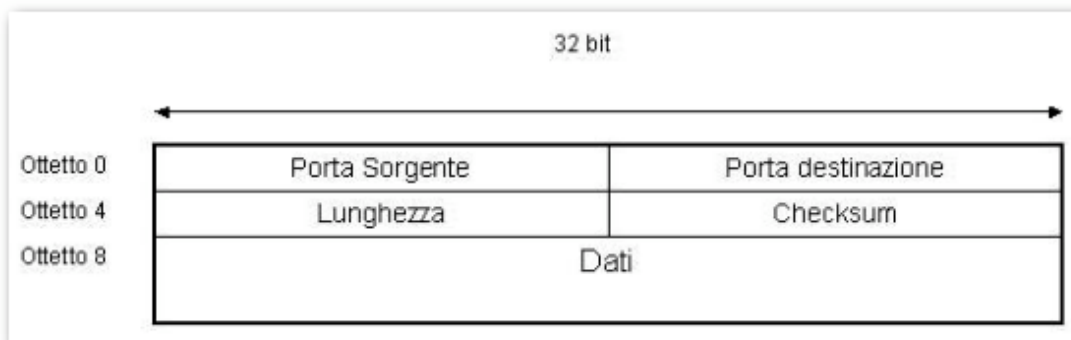
Figura 99: Segmento di un datagramma UDP
